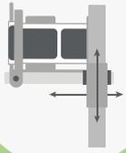
Adaptation à votre convoyeur optimisée grâce à un pied support réglable en hauteur et en transversal
