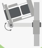
Mise en fonction d'un poste de dessus ou de côté par simple basculement de la noix de réglage (en inclinaison et en angle de pose)
