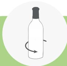
Ajustement de votre habillage bouteille par indice de repérage ; orientation par cran de fond et/ou optique et/ou spot UV
