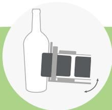
Précision de l'habillage sur bouteilles coniques par inclinaison des postes d'étiquetage
