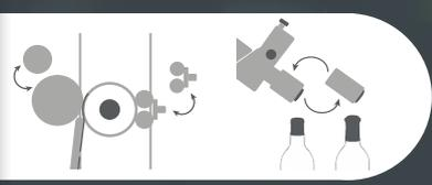
Rouleaux lisseurs et têtes de blocage interchangeables pour s'adapter à vos multiples produits
