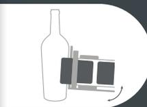
Gestion de la distribution de caspules (Ø28 à Ø36) par changement de godets sur mesure et interchangeables
