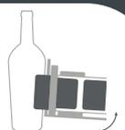
**Précision de l'habillage** sur bouteilles coniques par **inclinaison de poste**
