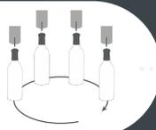
**Quadruple têtes de sertissage rotatives vin tranquille** garantissant un **niveau de cadence élevé !**
