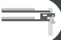
Ce **magasin horizontal à double étage** appuie dès la distribution de capsules une cadence élevée (environ 40 barreaux)
