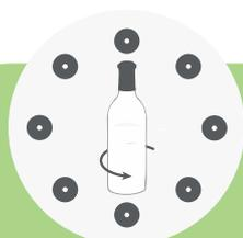
Ajustement de votre habillage bouteille par repérage : capteur d'orientation par cran de fond et/ou optique unique pour les 8 sellettes
